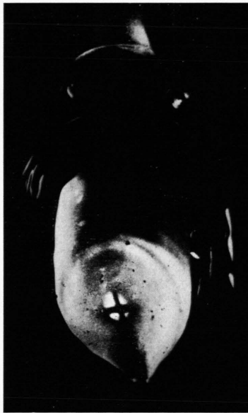
Abb. 4. Schatten eines Glaskreuzes in \text{H}_2\text{O} -Molekularstrahlen.
